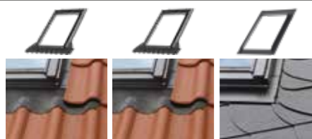
EZR 0000 Комір для профільованого покрівельного матеріалу до 45 мм EWR 0000 Комір для профільованого покрівельного матеріалу до 120 мм ESR 0000 Комір для плоского покрівельного матеріалу
